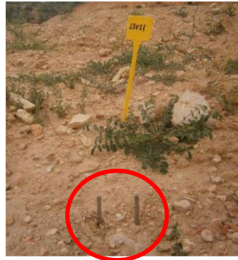
Instrumental para la medida de la humedad edáfica: TDR y varillas (sensores) de humedad
