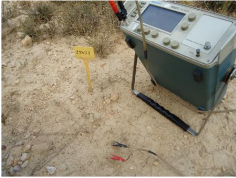
Instrumental para la medida de la humedad edáfica: TDR y varillas (sensores) de humedad
