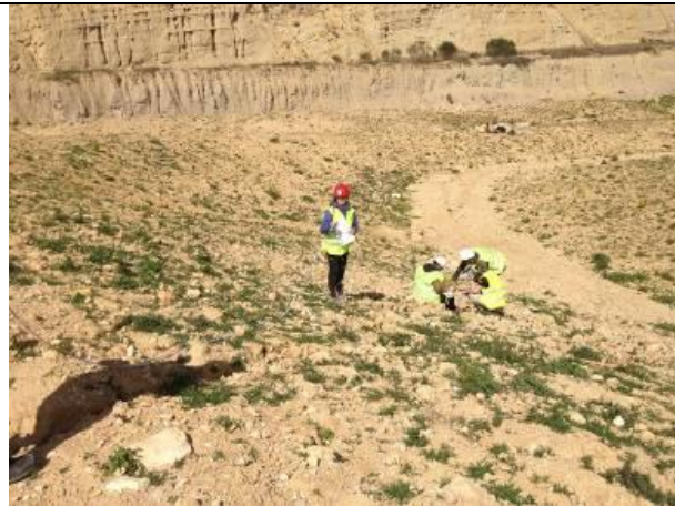
Estudio de regueros. Medición in situ del volumen de materiales erosionados en una cárcava desarrollada en Pastor I, como punto de partida para el cálculo de tasas de erosión hídrica.
